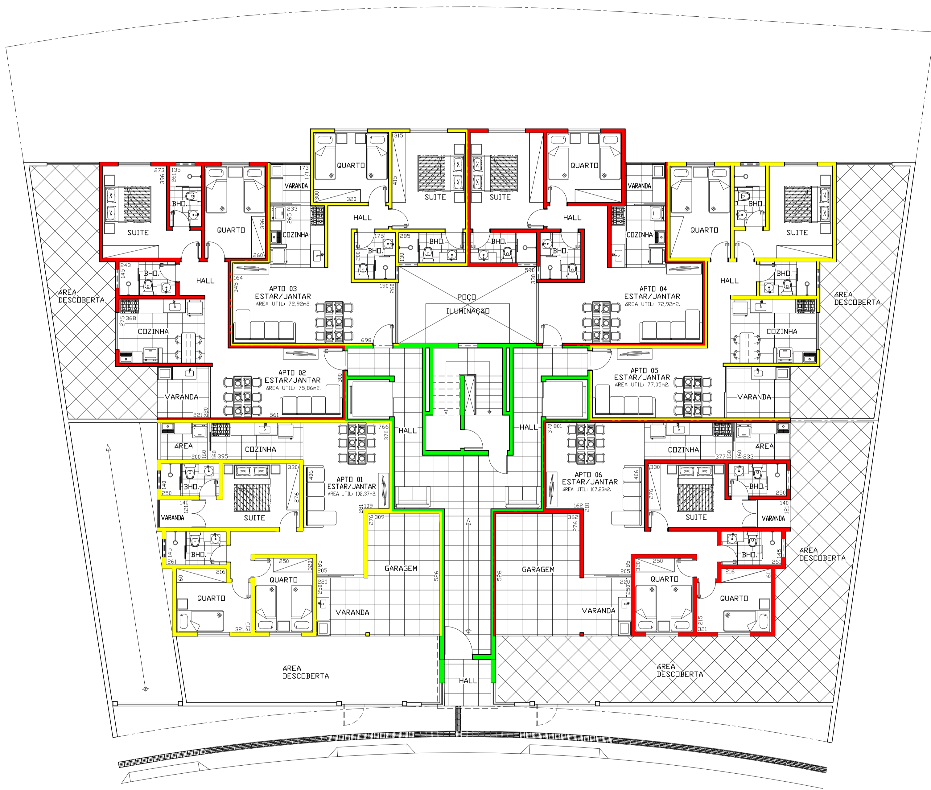
Planta Baixa Pavto. Térreo - (Nível +0,10) Escala 1/100
